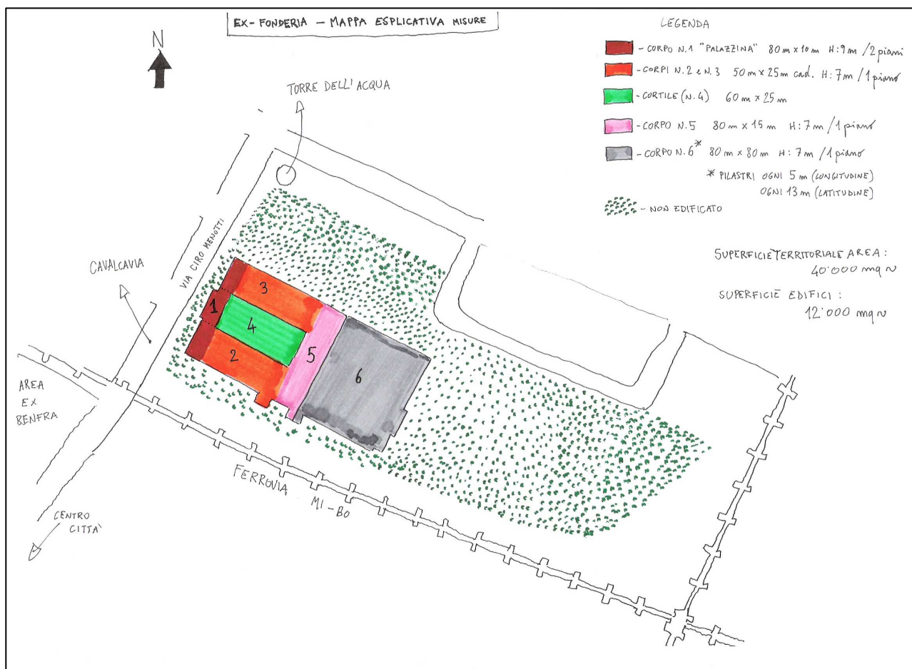
Figura 6.1. I sei corpi che formano il fabbricato delle ex Fonderie Riunite e relative dimensioni.
