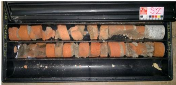
ID S2 - INDAGINE IN FONDAZIONE MEDIANTE CAROTAGGIO IN CONTINUO
