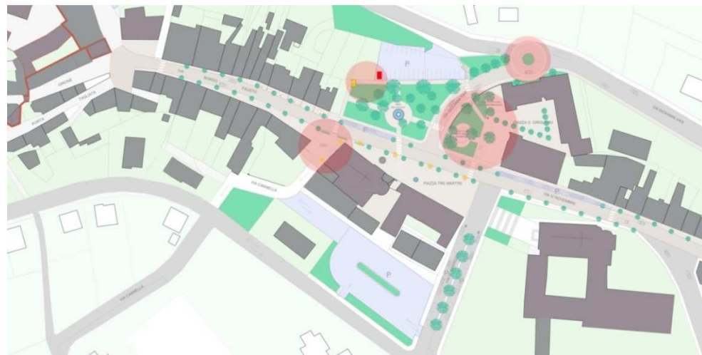
13. Ipotesi Progettuale: Soluzione C (Creazione di rotonda tra Via Papa Giovanni XXIII e Via Circonvallazione; spostamento cabina ENEL dal Giardino Pubblico; specializzazione aree esterne del comparto S. Girolamo e Teatro Petrella; Valorizzazione e limitazione traffico veicolare in P.zza Manzi).
