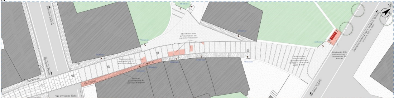
Planimetria della porzione alta di via Trieste: in rosso le porzioni di pavimentazione da recuperare
