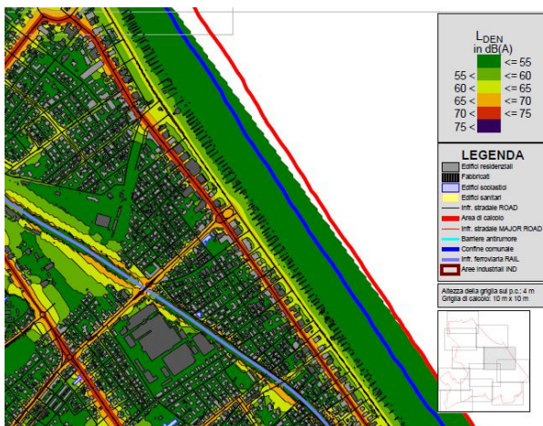
Mapa acustica ante operam LDEN (fonte “Mappatura Acustica Strategica dell'Agglomerato di Rimini - Aggiornamento 2017”)
