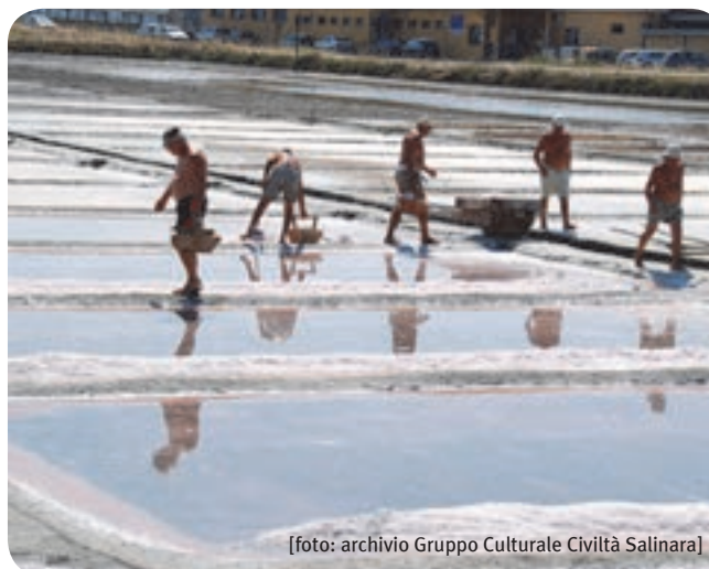
8 . Salina Camillone, dove ancora si utilizza il sistema della raccolta multipla.
